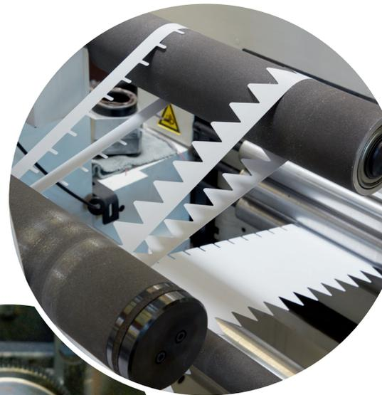
*Unsere Rotationsstanzen sind nicht nur präzise, sondern auch sehr effizient. In der Minute fährt die Schnittwalze bis zu 200 Meter Folie ab.*
